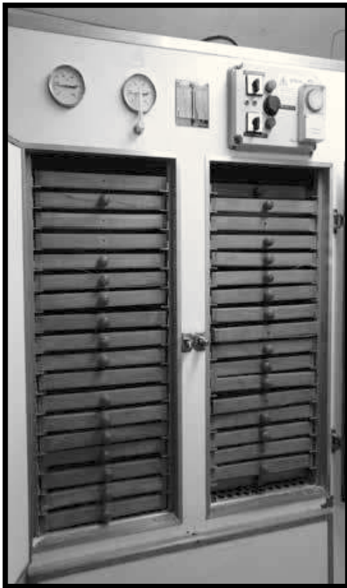
slika 5. Sušara sa isprekidanim načinom rada
